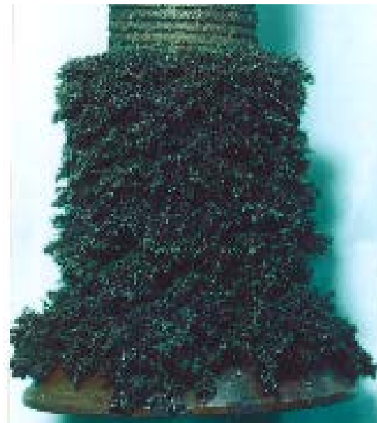
電解法にて回収した1kg金属ウラン (電力中央研究所との協力研究)
